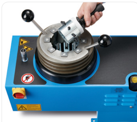
Schnelles Einsetzen der Backen
