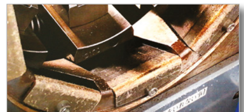
Gleitlager im Zustand nach ca. 900.000 Pressungen
