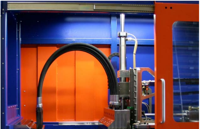
Abb. 3 Impuls-Prüfstand beim Schlauchleitungshersteller
