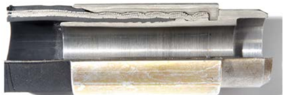
Abb. 17 Beispiel ausreiß- sichere Armatur
